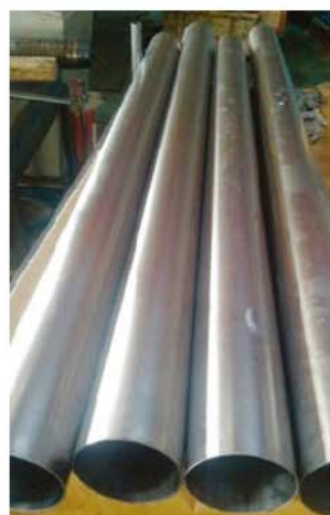
图2 实验熔盐回路堆用控制棒外套(GH3535合金无缝管φ115mm×1.5mm×2.5m)
