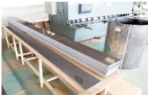
图1 金属所研制的碳化硼铝中子吸收材料薄板与焊接圆筒
