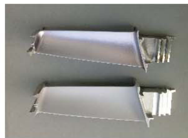
图3 经“绿色”渗铝处理的高温合金叶片，有涂层的叶身部分呈玫瑰色，无涂层的叶根和叶尖部位呈金属本色
