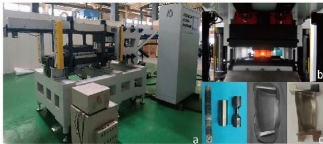
航空发动机用叶片楔横轧制坯技术与装备：(a) IM500型伺服液压板式楔横轧机；(b) 航空发动机用高温合金叶片坯料的板式楔横轧加工；(c) 从左到右分别是高温合金棒料、板式楔横轧件、叶片终锻件和成品。
