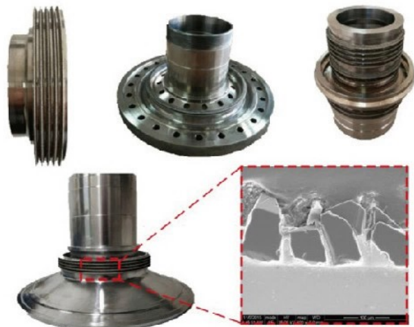
镀制的转子部件及涂层微观结构
